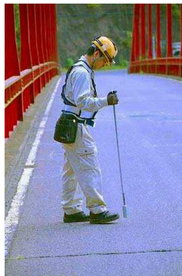
<アイハンマーはコンクリート床版、鋼床版など様々な現場で使用されています>
