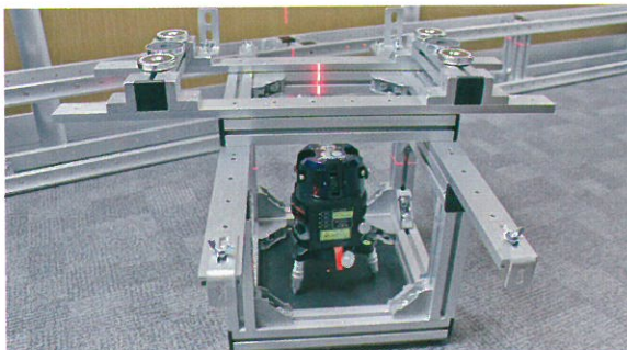
同じ高さで位置を変えながら測量を行うため、平井さんが製作した計測補助具
